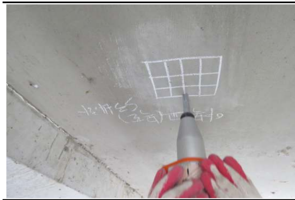
<그림 3.3.2> 반발경도법을 이용한 비파괴시험 현황
